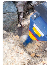
Spezialbohrkopf zum Entfernen von Baumstämpfen an unzugänglichen Stellen.
